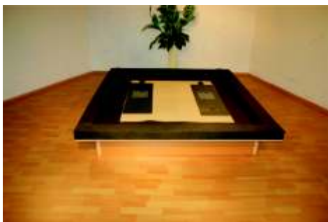
Festschrauben des unteren Schaums und Montage der Heizungen
