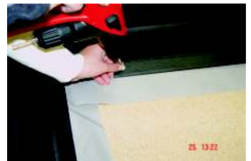
Auflegen des Nessesels und des oberen Schaums, wobei der Nessel mit dem oberen Schaum an die Bodenplatten geschraubt wird
